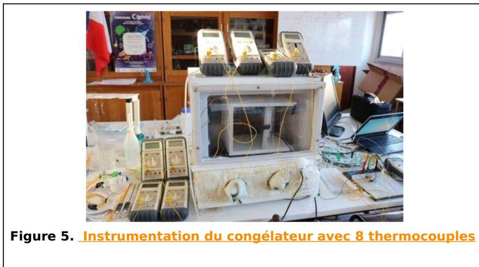
**Figure 5. Instrumentation du congélateur avec 8 thermocouples**
