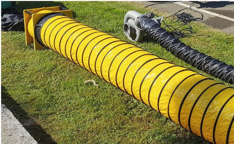
↑ PHOTO 3 Exemple de deux types de ventilateurs. Ceux-ci sont équipés de gaines souples annelées, étirées au maximum afin de favoriser au mieux l'écoulement de l'air insufflé dans l'ouvrage.
