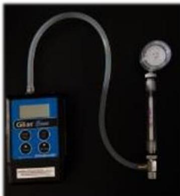
Figure 1 : dispositif de prélèvement pour un mélange particules-gaz associant un filtre et un support adsorbant en série.
