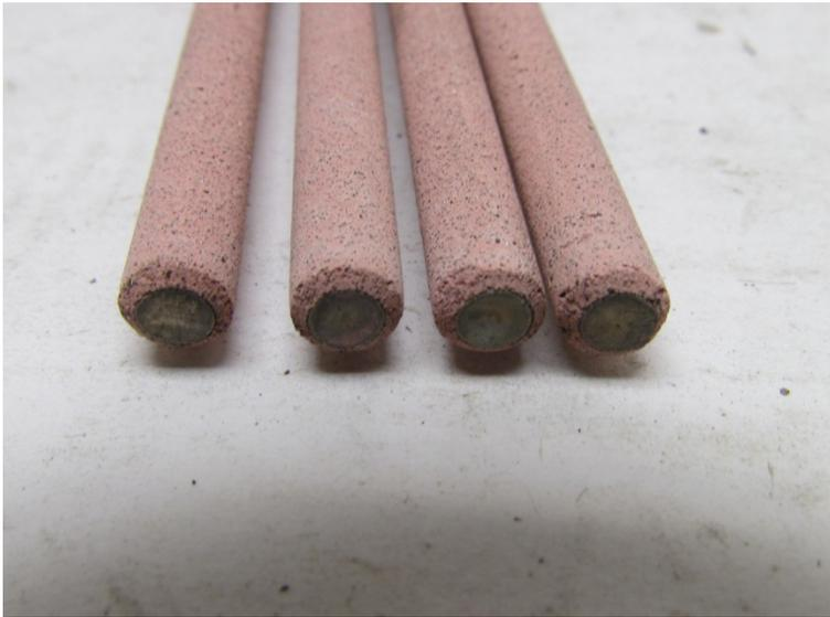
Enrobage de l'électrode = mélange de poudres minérales et métalliques agglomérées par un liant silicate sodium et/ou potassium
