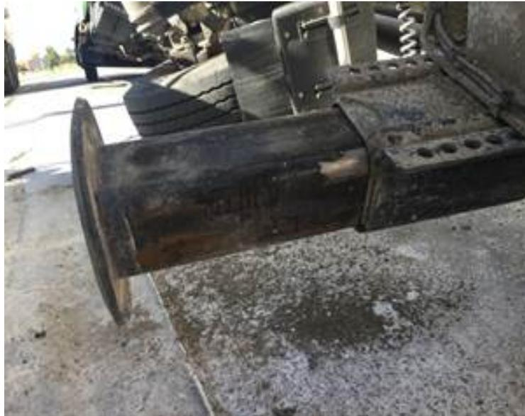
Béquille non déformée: la chute de matière créé un effet dynamique sur la suspension à air (non vidée) entraînant un soulèvement de la béquille et basculement
