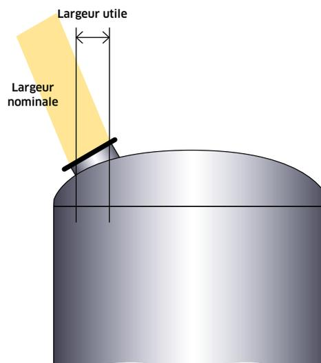
← FIGURE 1 : Largeur nominale et largeur utile d'une ouverture de cuve.
