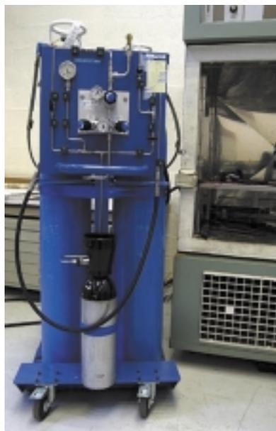
**Fig. 6. Circuit raccordé à l'alimentation d'air en essai climatique** - *Circuit connected to the air supply for climatic testing*
