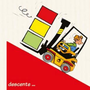
Sur plan incliné, je circule avec **la charge vers le haut de la pente** (marche arrière en descente et marche avant en montée).
