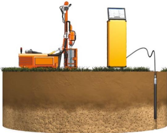
■ Figure 12. Forage destructif + essais pressiométriques
