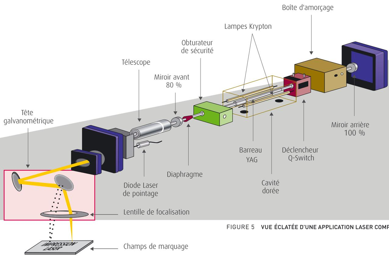
FIGURE 5 VUE ÉCLATÉE D'UNE APPLICATION LASER COMPLÈTE
