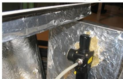
Sortie air comprimé
