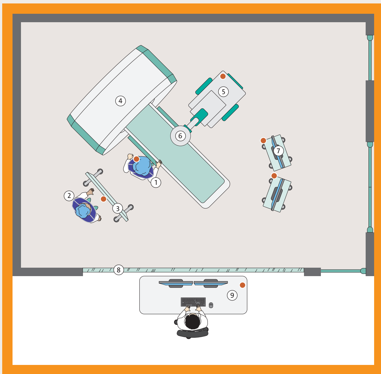
Schéma A: Disposition de la salle et des professionnels dans le cadre de l'étude sur le scanner interventionnel
